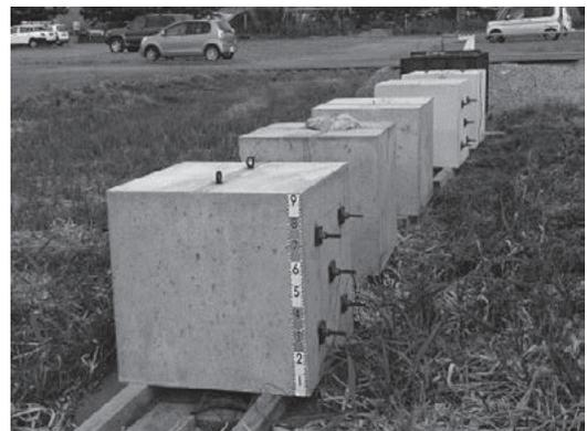
図1 暴露中のボス供試体
