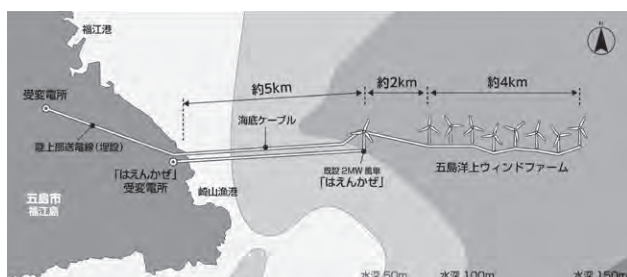
図3 浮体式洋上風力発電設備の配置図
