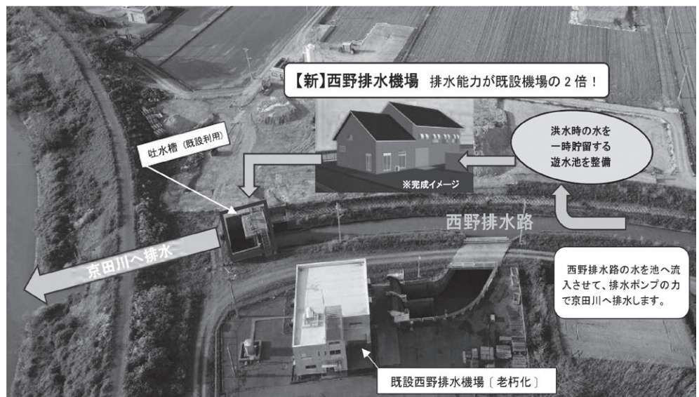
西野排水機場工事概要図
