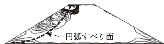
Fig.3 円弧すべり面形状( Fs \approx 1.0 )と最大せん断ひずみ分布( khc \approx 0.35 )
