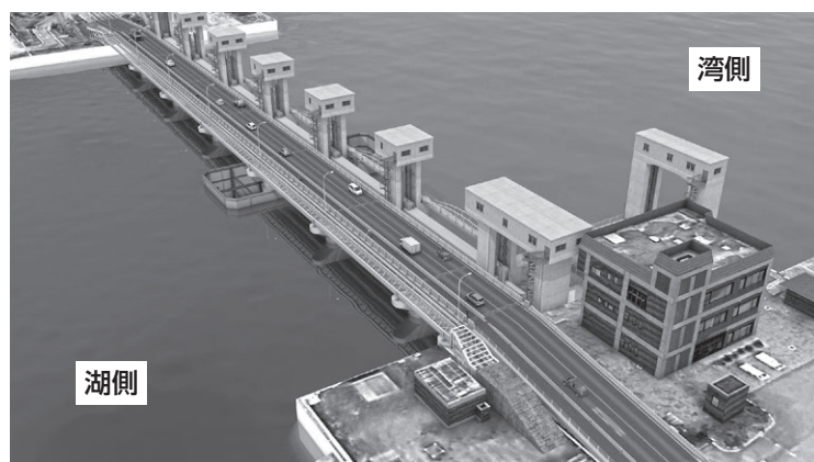
仮締切設置3D図
