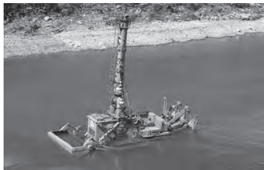
写真1 水陸両用ブルドーザD155W 43.5t級
