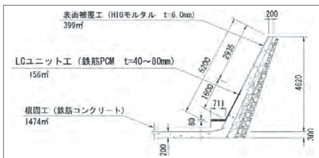
図3 沈砂池補修補強断面図
