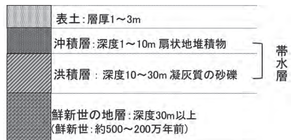
図2 泉田地区の地下地質の概要
