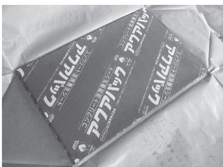
写真1 湿潤養生シートの外観
