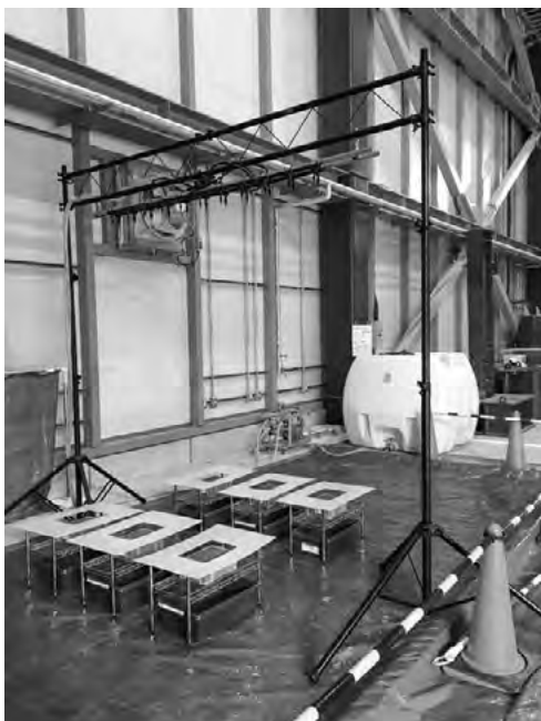
写真4 耐雨性能試験の状況
