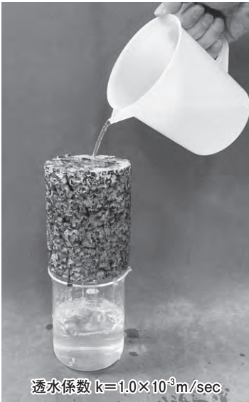
写真1 透水性改良体
