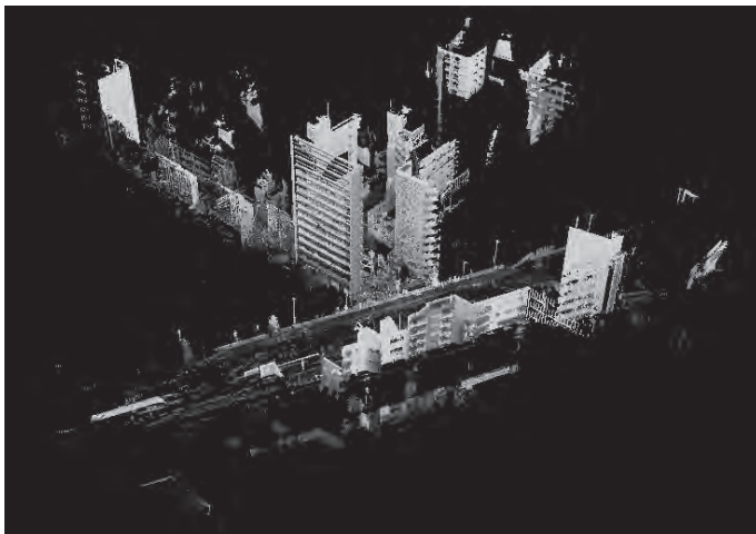
図1 建築現場での3D TLS活用
