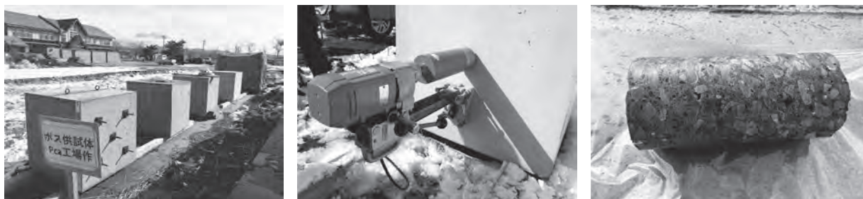
写真1 ボス供試体の暴露およびコア採取の状況
